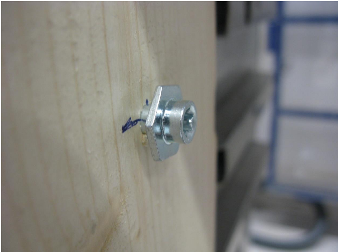
Bild 2: Montageskruvarna monterades direkt in i testriggens virke.
