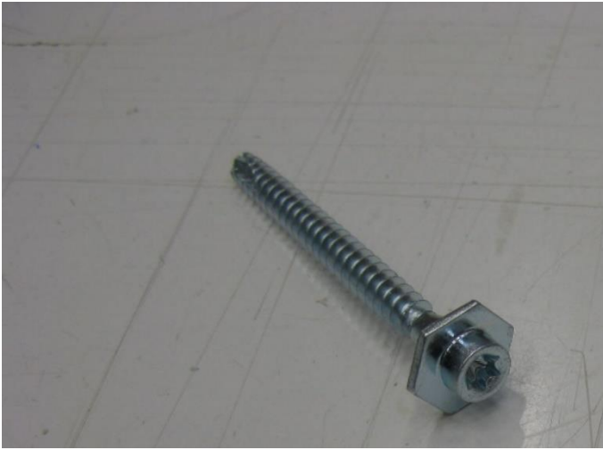
Bild 3: En montageskruv. Finjustering kan ske på 6-kantshuvudet när fönstret är monterat.
