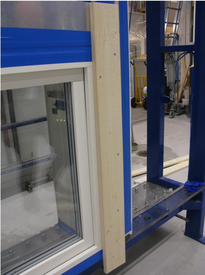
Bild 4: Fasad bräder monterades på fönstret som extra stöd, provning 1, och plockades bort för de andra provningar.
