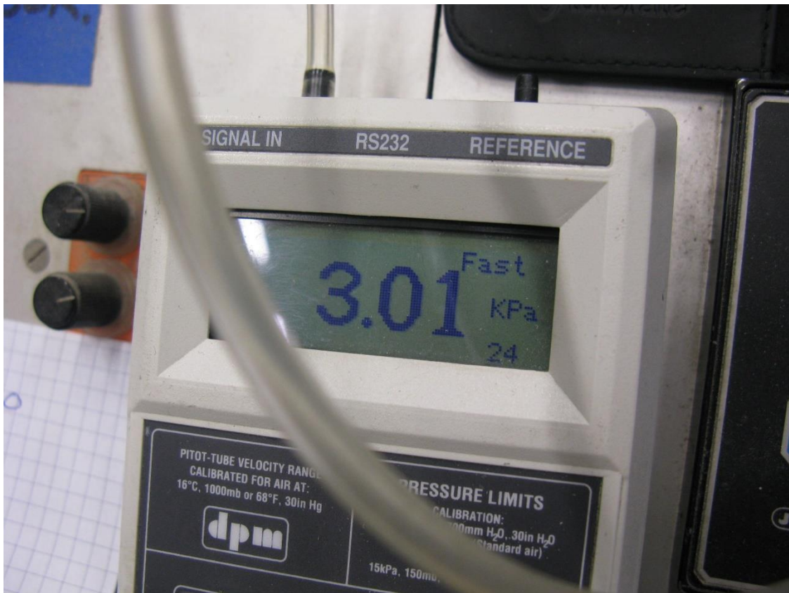
Bild 7: +3000 Pa vindlast kördes i minst 60 sekunder vid provningen.
