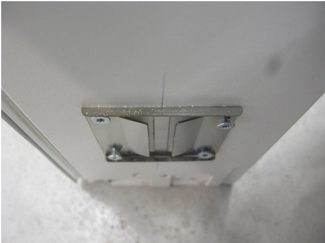
Bild 8: Inga skador noterades på fästena efter provningen.
